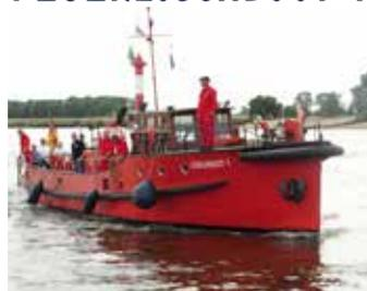
Das 1941 gebaute Feuerlöschboot 1 war in seiner aktiven Zeit in den Bremerhavener Häfen tätig. Heute wird das denkmalgeschützte Löschboot 1 von einer ehrenamtlichen Crew gehegt und gepflegt. Der 200 PS starke Antrieb des offenen Zylinders kann mit seiner Pumpe 50m hoch Wasser spritzen.
