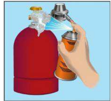
Bild 5 Dichtheitsprüfung der Anschlussverbindung
